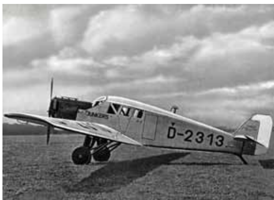
Junkers F13, erstes Verkehrsflugzeug in Ganzmetallausführung, 1919 (beide Fotos: Archiv Bernd Junkers)
