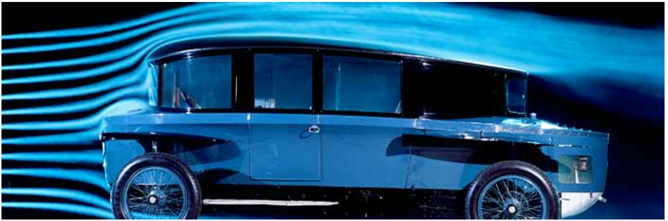
Rumpler-Tropfenwagen von 1921 im neuzeitlichen Windkanal von Volkswagen (SDTB/Foto: Clemens Kirchner)
